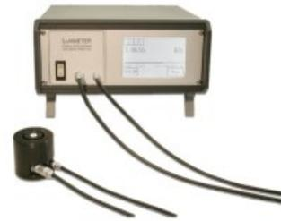
La cellule photoélectrique est thermostatée à  $35^\circ\text{C}$  et elle est fournie avec un support pour l'ancrage au plancher ou au plafond. Le support d'ancrage est équipé d'un système de réglage précis pour les divers alignements et d'un laser pour le centrage du luminaire/de la lampe.
