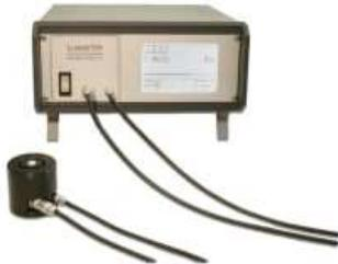
La cellule photoélectrique est connectée au luxmètre au moyen d'un câble blindé dont la longueur n'excède pas 70m: s'il est nécessaire d'augmenter cette distance il conviendra de considérer un amplificateur de signaux.
