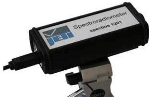
On peut faire des mesures ponctuelles ou conformément à la norme IESNA LM-79 et EN 13032-4 à l'aide du module Gonwin SP du logiciel Gonwin pour la gestion de la machine en définant un nombre n de demi-plans C- à mesurer.
