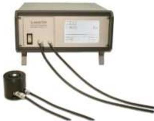
La fococélula, que se suministra montada sobre el brazo rotatorio, está unida al luxómetro a través de un cable apantallado de una longitud máxima de 70m: en el caso en que resulte necesario incrementar dicha distancia será oportuno añadir un amplificador de señal.
