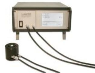
La fotocellula è termostattizzata a  $35^\circ\text{C}$  e viene fornita completa di sostegno da ancorarsi a pavimento o a soffitto, dotato di tutti i sistemi di regolazione fine per i vari allineamenti e laser per la verifica della centratura dell'apparecchio-lampada.
