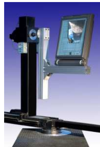
Fig.3 – Goniofotometro a rotazione dell'apparecchio
