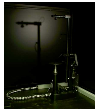
Fig.2 – Goniofotometro a rotazione della fotocellula
